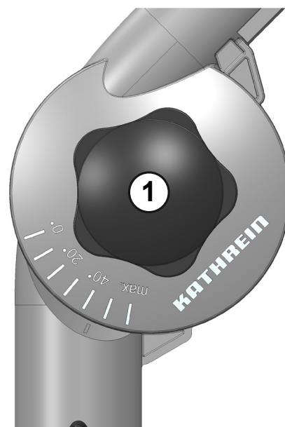
Abb. 6: Sterngriffschraube mit Adaptergelenk
